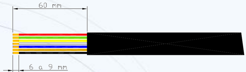
Corte de cable de 7 vías 52700 para ABS al ser instalado en en conector de 7 vías Tectran 38283 o TruckLite 50869
